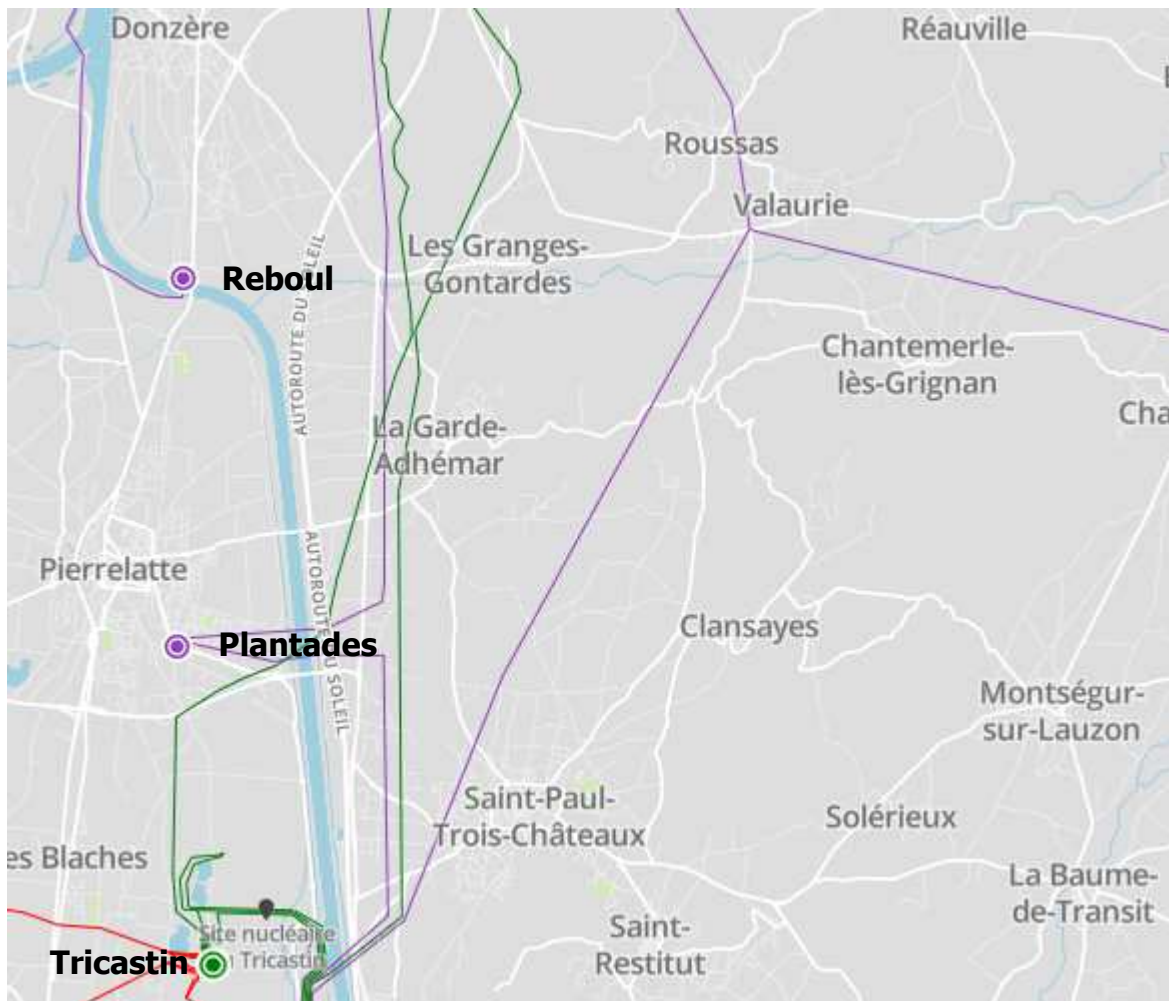
Figure 208 : Postes sources sur le territoire (source : capareseau.fr)
