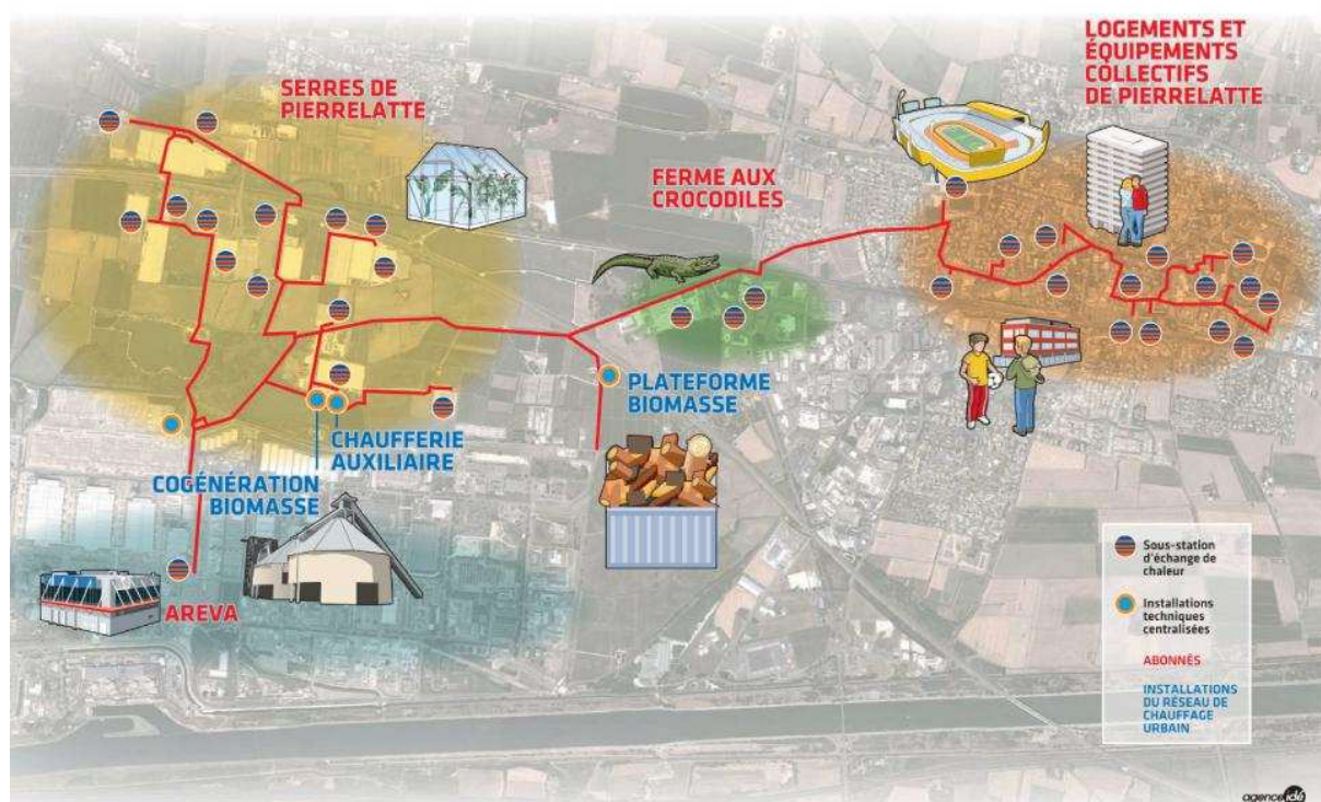
Illustration du réseau de chaleur de Pierrelatte, source : Coriance
